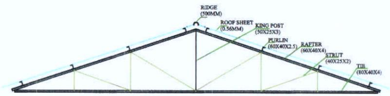
**DETAILS OF ROOF TRUSS**
