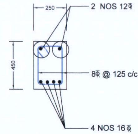
SECTION AT MID SPAN FOR TOP BEAM
