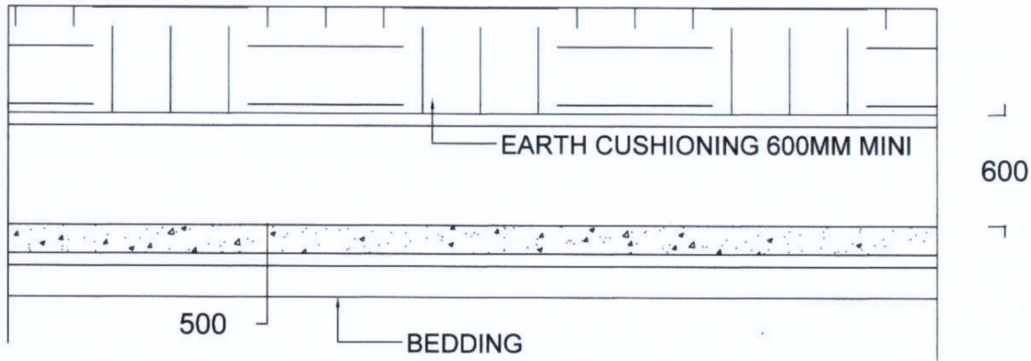
LONGITUDINAL SECTION OF HUME PIPE CULVERT
